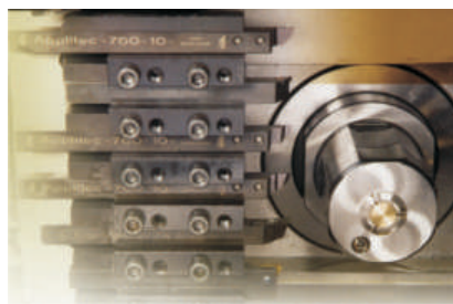
4 невращающихся осевых инструмента 6 позиций для токарных резцов
